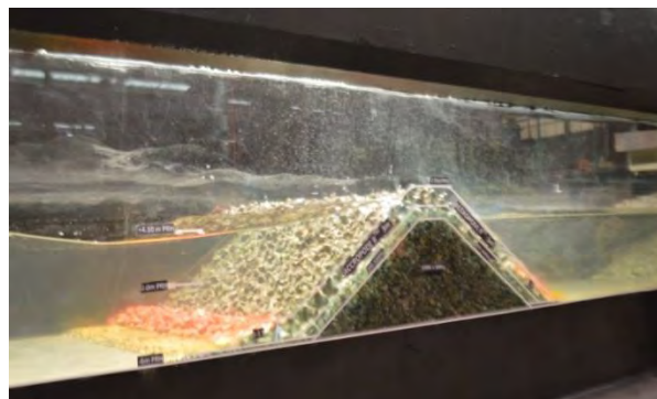
Reproduction des conditions naturelles de sites faisant l'objet de projets d'aménagement. Étude du comportement d'une digue. Société Artélia © Sierg.
